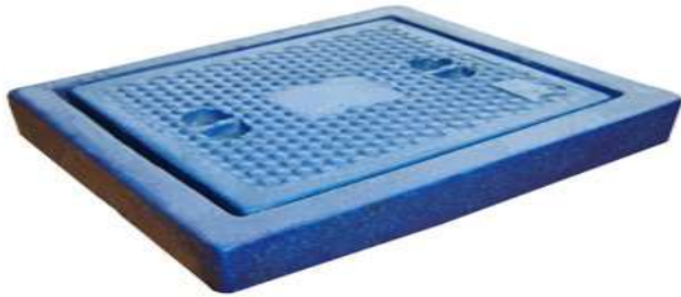
BROCAL CON TAPA PARA REGISTRO 70.6x50.6x8.5 CM FABRICADA EN POLYCONCRETO PARA USO PEATONAL PESO APROXIMADO 31 KG
